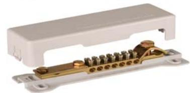
Durch Isolations- oder sonstige Fehler, über Rohre, Abschirmmäntel von Koaxialkabeln oder sonstige metallenen Verbindungen übertragene Spannungen gegenüber einem anderen Potenzial sollen vermieden werden. Durch Verbindung von Heizungs-, Wasser- und sonstigen Installationsrohren untereinander mit 6-25 qmm Kupferdraht (je nach Querschnitt der Schutzleiter), und dem weiteren Anschluss der Koaxialkabelabschirmungen, der Verstärker, Multi-
